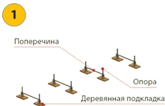
5.1. Устанавливаем деревянные подкладки. На них устанавливаем винтовые опоры. Каждую пару опор соединяем между собой поперечиной.
