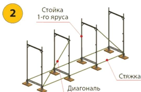
5.2. На внешней и внутренней стороне лесов, на фляжки поперечин, устанавливаем стяжки. На винтовые опоры выставляем стойки 1-го яруса, соединив их диагоналями. Диагонали ставятся через одну секцию.
