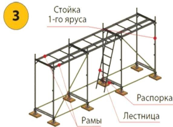
5.3. Устанавливаем лестницу на швеллер стойки. Для наклонного положения лестницы используем распорку (только на первом ярусе!)
